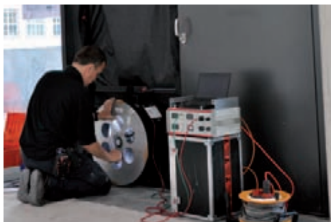
Blower-Door-Test im Einsatz bei einer Luftdurchlässigkeitsprüfung nach DIN EN 13829 (Bild: Ing.-Büro n50, Torsten Bolender)
