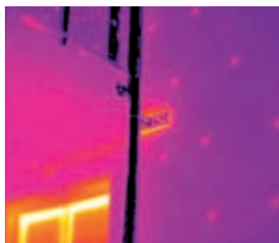
Im Gegensatz zum auskragenden Balkon sind bei dieser selbsttragenden Balkonkonstruktion kaum Wärmebrückeneffekte auszumachen.
