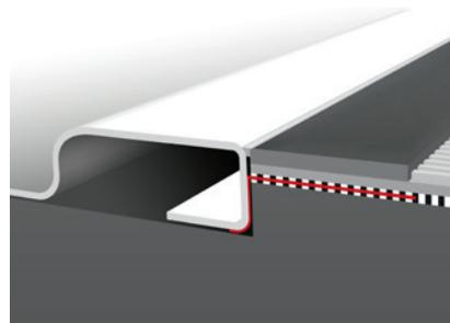
**3.** Auftragen der SCHOMBURG Verbundabdichtung im Bereich des ASO-Anschlussdichtbandes. Platzieren und Ausrichten der Duschwanne in den Eckbereich. ASO-Anschlussdichtband sorgfältig und faltenfrei in den ersten Auftrag der SCHOMBURG Verbundabdichtung an den Wänden und am Bodenanschluss einarbeiten. Überlappungen mit AQUAFIN-RS300 oder AQUAFIN-1K-Premium verkleben.
