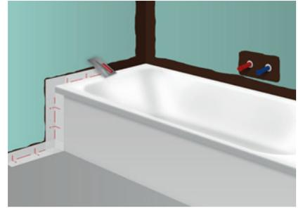
**3.** ASO-Dichtdecke-I im Wand-/Bodenanschlussbereich und ASO-Dichtband-120 im Wandanschlussbereich der Wanne sorgfältig und faltenfrei in den ersten Auftrag der SCHOMBURG Verbundabdichtung einarbeiten. Überlappungen mit AQUAFIN-RS300 oder AQUAFIN-1K-Premium verkleben. Überarbeiten der Dichtbänder und Herstellen der Flächenabdichtung mit SCHOMBURG Verbundabdichtung.
