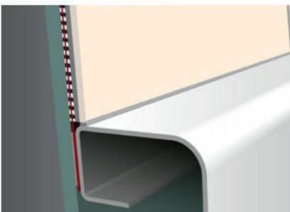
**4.** Schnittdarstellung der Verklebung ASO-Anschlussdichtband an den Wannенrand. Zur Verminderung von Schallübertragung sind geeignete Maßnahmen, wie z.B. Schallminderungsstreifen, vorzusehen. Ggf. ASO-SB zum Schutz der ASO-Dichtbandtechnik verwenden.
