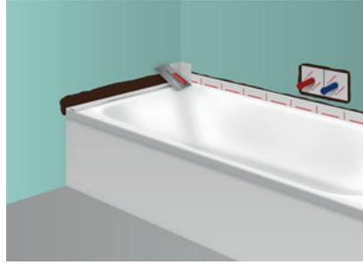
**2.** Auftragen der SCHOMBURG Verbundabdichtung im Bereich des ASO-Anschlussdichtbandes. Platzieren und Ausrichten der Wanne in den Eckbereichen. ASO-Anschlussdichtband sorgfältig und faltenfrei in den ersten Auftrag der SCHOMBURG Verbundabdichtung einarbeiten. Überlappungen mit AQUAFIN-RS300 oder AQUAFIN-1K-Premium verkleben.
