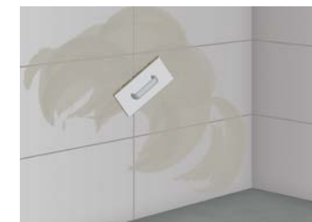
8 Nach Anziehen des Fugenmörtels emulgieren
