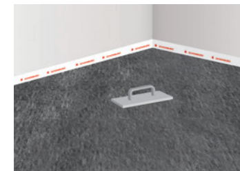
7 Abreiben und Fertigstellung der Estrichfläche
