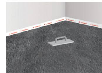
7 Abreiben und Fertigstellung der Estrichfläche
