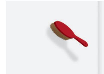
1 Geeigneten, tragfähigen Untergrund gründlich reinigen
