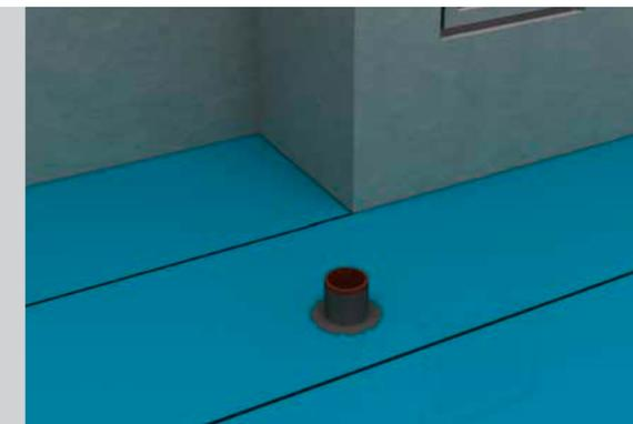
4. Bei Durchdringungen, wie z.B. Leerrohren, wird die Gefitas Feuchtigkeitssperre an diese herangeführt und mit dem elastischen „Gefitas Fixierband“ hohlstellenfrei angeschlossen. Dabei werden die Klebestreifen spannungsfrei von oben nach unten, überlappend, aufgelegt und angedrückt.
