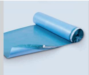
Gefitas® PE Parkettunterlage Standard 2/250 besteht aus elastischem 2 mm PE-Schaum (RG ca. 25 kg), beschichtet mit einem 250 µm dicken PE-Laminat. So schützen Sie den Laminat- oder Parkettboden vor Feuchtigkeit aus dem Estrich. Die Unterlage ist mit einer selbstklebenden 100 mm breiten Überlappung ausgestattet, wodurch Aufdopplungen bei der Verlegung vermieden werden.
