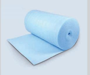
Beim Begehen von Böden oder z.B. durch Stühlerücken entstehen Geräusche, welche als Körperschall im angrenzenden Bauteil weitergeleitet und als Luftschall in benachbarten Räumen akustisch wahrgenommen werden. Die Geficell® PE TDZ-6.0-1.0 Trittschalldämmung aus feinem, geschlossenzelligem PE-Schaum erreicht ein Trittschallverbesserungsmaß von bis zu 19 dB. Bitte beachten Sie bei der Planung und Ausführung die allgemeine bauaufsichtliche Zulassung und unsere Verlegeanleitung.
