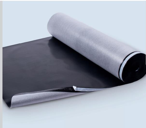
Die Gefitas® PE Dampfsperre 1/250 besteht aus einem hochwertigen, geschlossenzelligen 1 mm starken PE-Schaum und einer 250 µm PE-Laminatschicht. Bei rauem Untergrund ist daher ein Vlies als zusätzliche Lage nicht mehr notwendig. Der integrierte Dichtrand ermöglicht eine einfache Verklebung der Bahnen untereinander. Mit dem dazu kompatiblen Gefitas®-Zubehör wird für Luftdichtigkeit gemäß den Anforderungen an die dampf- und luftdichten Anschlüsse gesorgt.
