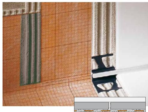
Auch bei feuchtigkeitsempfindlichen Untergründen wie Holz, Gipskarton, Gipsputz können Dampfsperren sinnvoll sein. Ergänzend zu Schlüter®-KERDI sind Innenund Außenecken sowie Rohrmanschetten lieferbar. Zum Abdichten von Stoßverbindungen oder Eckanschlüssen wird das Schlüter®-KERDI-KEBA (Band) in den Breiten 8,5/12,5/15/18,5/25 cm angeboten. Zur Abdichtung über Bewegungsfugen oder flexiblen Randfugen dient Schlüter®-KERDI-FLEX in Breiten von 12,5 cm oder 25 cm.
