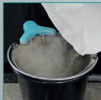
Der DUST.ex saugt das Material bereits im Eimer ab, so gut wie kein Staub entweicht.
