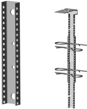
Rigips Nonius Verbinder dienen zur Verbindung von Nonius Oberteilen und Rigips Nonius Stangen bei der Ausbildung von Abhängungen in Gipsplattensystemen im Deckenbereich. Die Verwendung erfolgt in Verbindung mit je zwei Sicherungsklammern.
