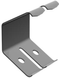
Rigips Doppelfedern dienen in Verbindung mit Rigips Ösen- oder Hakendrähten zur Ausbildung von Abhängungen in Gipsplattensystemen im Deckenbereich. Die Feder nimmt zwei Abhängedrähte auf und erlaubt eine variable Einstellung der Abhänghöhe.
