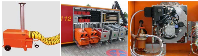
Gezielte Beheizung von 2 Räumen durch Anschluss von Warmluftschläuchen
