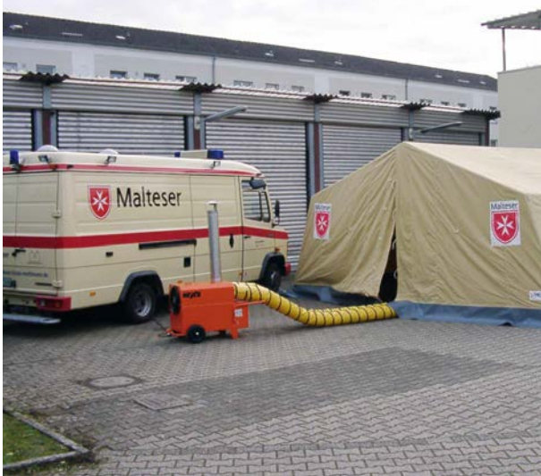
Temporäre Beheizung von Zelten
