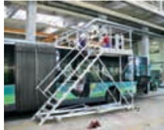
Schnell und garantiert sicher: Wartungsbühne mit Zentralfeststellung
