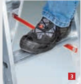
Die PREMIUM-Line und WORK-Line Stufenleitern (3) haben hochfest verbördelte Stufen-/Holmverbindungen mit 80 mm tiefen, profilierten Stufen für einen sicheren Aufstieg und ermüdungsfreien Stand, der Stufenabstand beträgt 250 mm.
