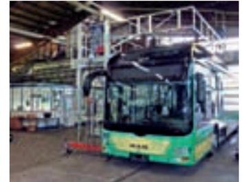
Robuste Einhausung: Mit Ausklappgeländer für zusätzlichen Schutz
