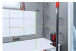
Die vertikale Linie bildet zusammen mit der horizontalen 360° Laserlinie einen 90° Winkel. Dieser dient zum perfekten Ausrichten z. B. beim Fliesenlegen oder Einbau von Einrichtungen und Möbeln.
